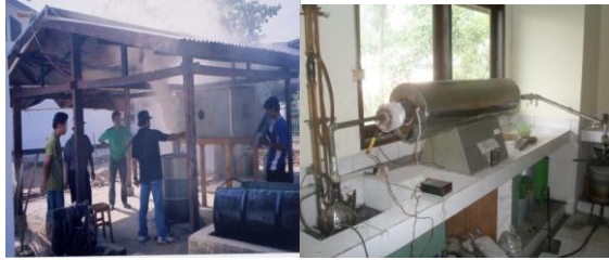
Gambar 1. Pembuatan arang menggunakan kiln drum (kiri) dan pembuatan arang aktif menggunakan retort listrik dan steam boiler skala laboratorium (kanan).
